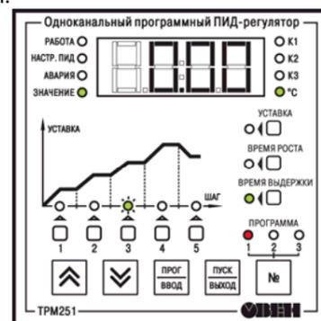
Таким образом вы установили параметры регулирования на третьем шаге:
